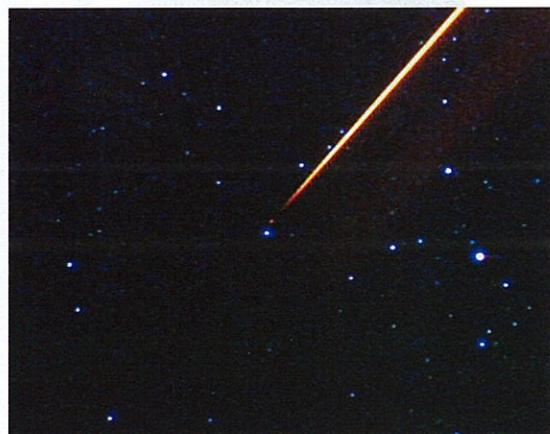
6月の試験観測では、天体観測用超高感度カラーレビューカメラ (NC-R550a) を使い、高度90kmに生成されたレーザーガイド星をカラー動画で撮影することにも成功した。散乱光が途切れただその先に11等星の明るさで輝くレーザーガイド星の様子がはっきりわかる貴重な映像だ。
